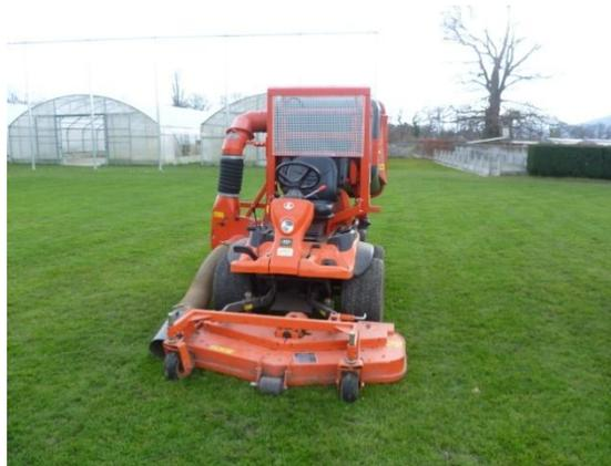
Tondeuses rotatives à disque avec bac de ramassage, permet une coupe haute.
